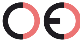
Falsche CE-Kennzeichnung (zu großer Zwischenraum)
